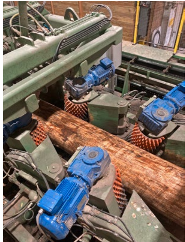
Winkelgenaue Eindrehung und Diagonalausrichtung der Stämme zur Steigerung der Schnittholz ausbeute.
