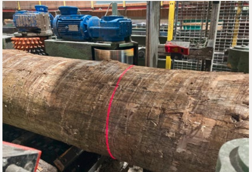
Mit einem 3D-Scanner wird von jedem Stamm ein digitales Abbild geschaffen.
