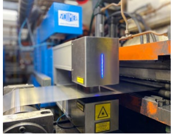
Eine neue Lasermessanlage ersetzt bei der MK Metallfolien GmbH das bestehende Isotopenmessverfahren zur Dickenmessung der Stahlbänder.
