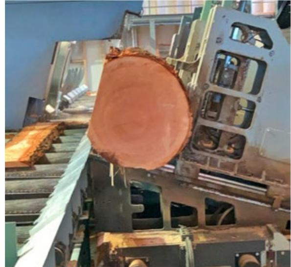
Die Blockbandsäge der Firma EWD beim effizienten Einschnitt eines Eschenstammes.
