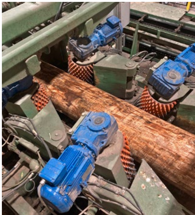
Winkelgenaue Eindrehung und Diagonalausrichtung der Stämme zur Steigerung der Schnittholzausbeute.
