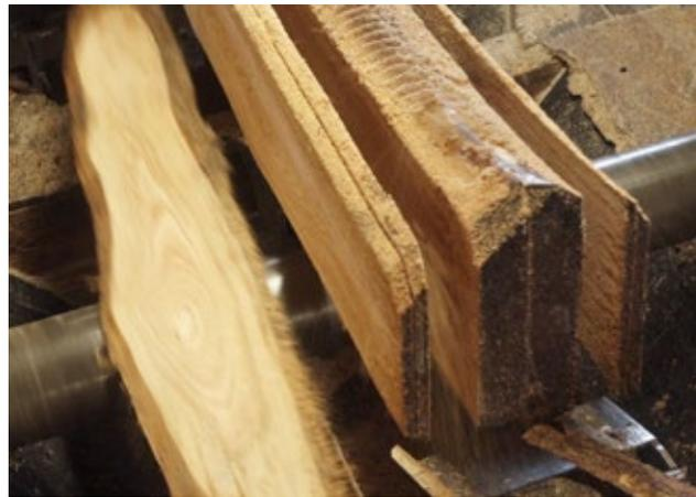
Die ungeschälten Stämme werden mit Hilfe einer Gattersäge zu Brettern verarbeitet. Eine neue Anlagensteuerung hilft, den Ausschuss zu verringern.
