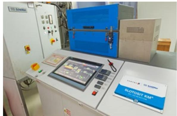
Der Schwefeltrioxid-Generator und die Steuerung der neuen Anlage in Arnsberg
