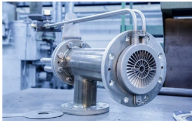
Die Stahlwerk Unna GmbH & Co. KG setzt heute effiziente, im 3D-Druck hergestellte Mischeinheiten der Kueppers Solutions GmbH aus Gelsenkirchen ein.
