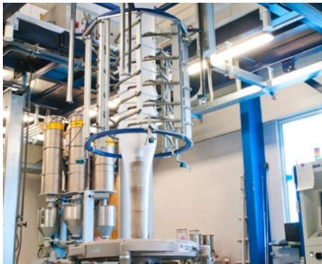
Zur Herstellung der Folien wird zunächst das Kunststoffgranulat in Extrudern aufgeschmolzen und zu einem Schlauch extrudiert.
