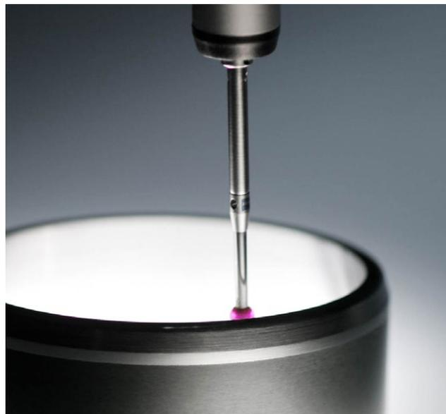
Bauteilmessung mit einer Zeiss-Messmaschine.
