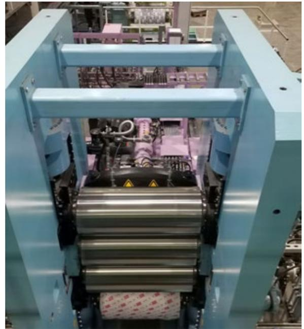
Im Vergleich zum bisherigen Stand der Technik spart das neue Verfahren jährlich bis zu 96 Prozent an Lösemitteln ein. Im Bild ist der Kalandr mit dem Extruder zu sehen.
