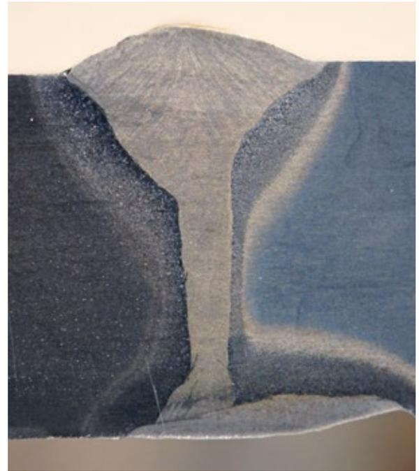
Aufnahme einer Schweißnaht mit geglätteter Wurzel
